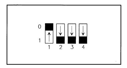
Scegliere un indirizzo (o codice di selezione) che sia diverso da quello di ogni altra scheda installata nel sistema. Il codice di selezione 7 è quello impostato in fabbrica, il più adatto per un computer HP Vectra. E' inoltre il valore predefinito per la connessione di stampanti e plotter. Anche i codici di selezione 3, 5 e 6 sono abbastanza comuni. Se è installata più di una interfaccia HP-IB, ciascuna di esse deve avere un diverso codice di selezione.
