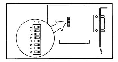
Per controllare la configurazione, confrontare la posizione dei singoli interruttori con quella illustrata precedentemente. Benché la configurazione sia soddisfacente per la maggior parte dei sistemi, è possibile modificarla
