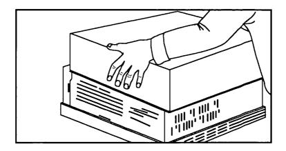
3. Escoja una ranura desocupada. Puede instalar la tarjeta en cualquiera de las ranuras del HP Vectra PC o del IBM PC o PC/AT. Escoja una ranura que le dé acceso libre al conector HP-IB, sin embargo, tenga en cuenta que no conviene situar la interfase junto a una tarjeta VGA. En el IBM PC/XT, puede instalarla en cualquiera de las ranuras con la excepción de la ranura 1 (la que está próxima a la fuente de alimentación).
