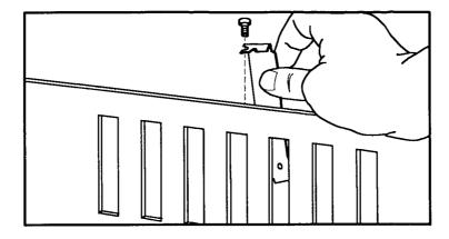
5. Nehmen Sie die HP-IB-Schnittstellenkarte aus der antistatischen Schutzhülle. Fassen Sie die Karte nur an den Kanten an.
