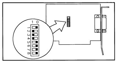
Para verificar la configuración, compare las posiciones de los conmutadores con las que se muestran en la ilustración. Esta configuración es adecuada para la mayoría de los sistemas; sin embargo, es posible que Ud. desee cambiar la configuración en una de las siguientes situaciones:
