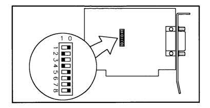
Wenn Sie Ihre Konfiguration überprüfen wollen, vergleichen Sie die Schalterstellungen Ihrer Karte mit den oben abgebildeten. Obwohl diese Konfiguration für die meisten Systeme verwendet werden kann, müssen Sie möglicherweise die Schalterstellungen ändern:
