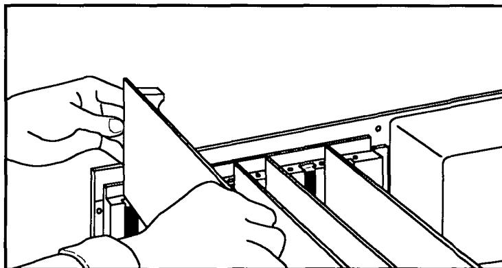
7. **Revissez la vis du couvercle de logement** pour maintenir la carte d'interface HP-IB en place. (Conservez le couvercle du logement pour le réutiliser si la carte est retirée ultérieurement de l'ordinateur.)
