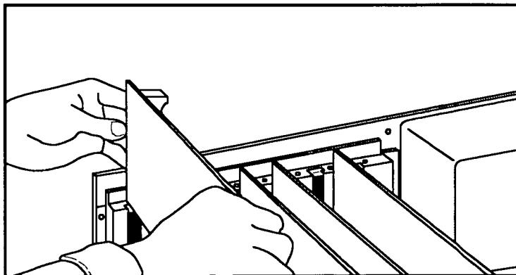
7. **Vuelva a poner el tornillo de la cubierta de la ranura** a fin de sujetar la interfase HP-IB en su lugar. Guarde la cubierta de la ranura, en caso de que necesite en alguna ocasión sacar la tarjeta del computador.
